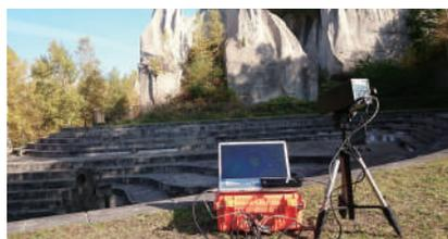
ラインセンサ方式のハイパースペクトルカメラと異なり、ステージスキャン方式を採用しているため、屋外での使用も快適に行うことができます。屋外に設置しての定時撮影も簡単なソフトの操作で可能です。
